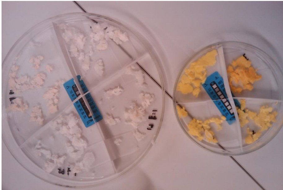
Figur 3.10 – (1:3-HA) bestrålt i SUNTEST til lysdose 22 540 kJ/m 2 (til venstre) og (1:3-HA) mørkekontroll (til høyre). Temperaturstrips viser en temperaturøkning > 60 °C i de bestrålte prøvene, mens temperaturen har holdt seg < 37 °C i mørkekontrollen.
