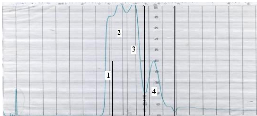
Figur 4.24: Elueringsprofil av M-60 etter behandling med alginatlyase og fraksjonering med en HiTrap Q Fast Flow kolonnen (5mL). Deteksjon foregikk ved hjelp av UV-detektor.
