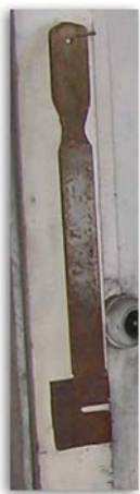
Figur 7. Spesialverktøy for oppretting av slagerbruer. Eget foto.
