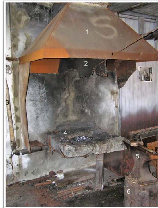
Figur 2. 1- Røykhetta, 2- Spjeld, 3- Rør til vifta, 4- Essa, 5- Smiusteet, 6- Smiustabben. Eget foto.
