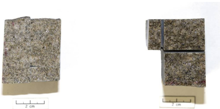
Figur 6.23: Prøve konsolidert med vannglass (KRYSTAZIL 40).
