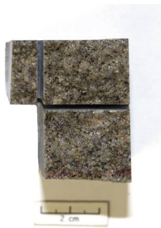
Figur 6.24: Prøve konsolidert med Paraloid B72 15 % i aceton.
