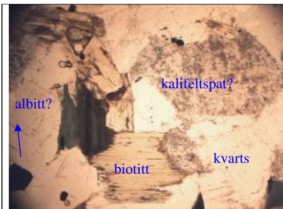
Figur 5.6: Illustrasjon av granittens mineralsammensetning: Tynnslip av prøvestein under krysspolarisert lys. 100x.
