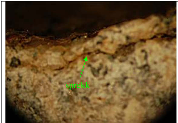
Figur 5.5: Forvittringssone med sprekk, fotografert gjennom arbeidsmikroskop.
