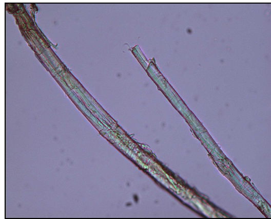
Figur 23: Fiber av lin fra referanse fotografert i lysmikroskop (200 x forstørrelse). Likhet til figur 17 indikerer at Maria bebudelse er malt på et linlerret.
