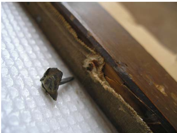
Stift fra tidligere oppspenning: generasjon 3 - stift fra tidligere oppspenning: generasjon 1
