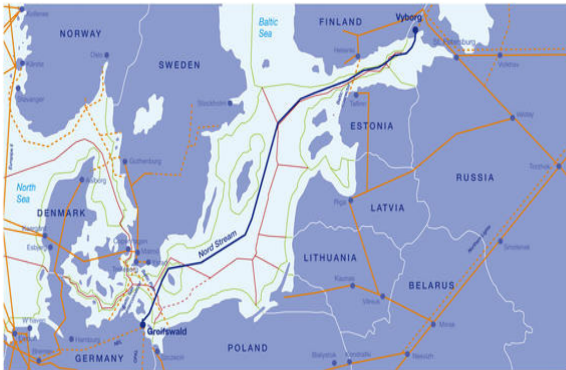
Schaubild 1: Die geplante Route der Nord Stream Pipeline; Quelle: Nord Stream
