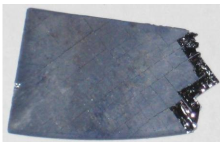
Figur 50: Si(004)-wafer reagert med Mg(g). Overflaten er oppsprukket i et kvadratisk mønster, og kvadratiske biter falle lett av.
