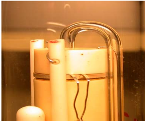
Figur 4.4 Bilder av målecellen som ble benyttet i brenselcelle- og 3-elektrodemålingene.
