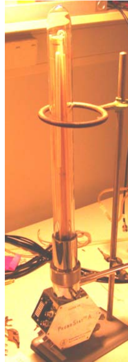
Figur 4.4 Bilder av målecellen som ble benyttet i brenselcelle- og 3-elektrodemålingene.
