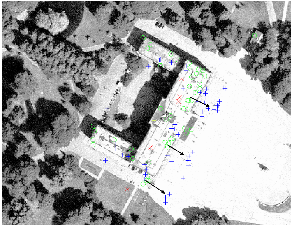
Figur 4.27 Slottet. Både punktene fra NGU (grønn) og EV (blå = Run 2, rød = Run1) indikerer mange stabile reflektorer på taket av Slottet, men punktskyen fra EV ser ut til å være parallellforskjøvet mot øst-sydøst (sorte piler).
