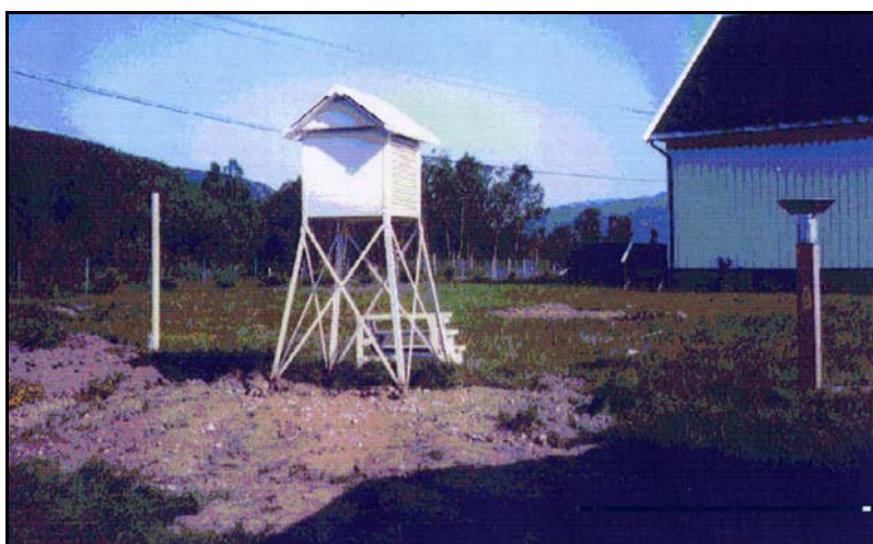
Figur 4.2: Værstasjonen 91760 Nordreisa-Øyeng med snødybdemåler til venstre for instrumenthytta, og nedbørmåler (pluviograf) til høyre. Bildet er tatt mot nord. Foto: P. T. Sørvoll (VNN Tromsø), juni 1992.
