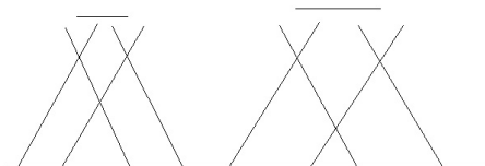
Figur 2.10: Basis — høydeforhold er forholdet mellom flyhøyde og avstanden mellom eksponeringene.
