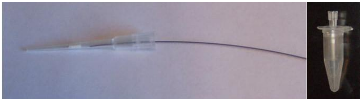
Figur 8 SPE-tip. Bildet (t.v.) viser en tillaget SPE-tip med metalltråd som har dyttet ned sorbentmaterialet. Bildet (t.h.) viser SPE-tip plassert i et eppendorfrør klar til bruk.
