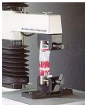
Figur 14 Tensile-test oppsett. Bildet er hentet fra Texture Technologies hjemmeside [72].
