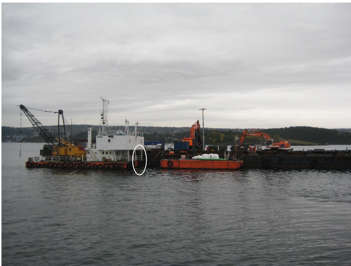
Figur 2. Bilde av lekteren hvor ekkoloddets plassering er markert (omringet). Deponering av sedimentmasser foregikk gjennom et rør på kortsiden av lekteren, plassert ca. 30 meter diagonalt til venstre for svingeren.
