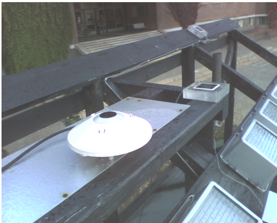
Figur 4.1: Oppsett av pyrgeometer (forgrunn) og pyranometer (på skrå i bakgrunn).
