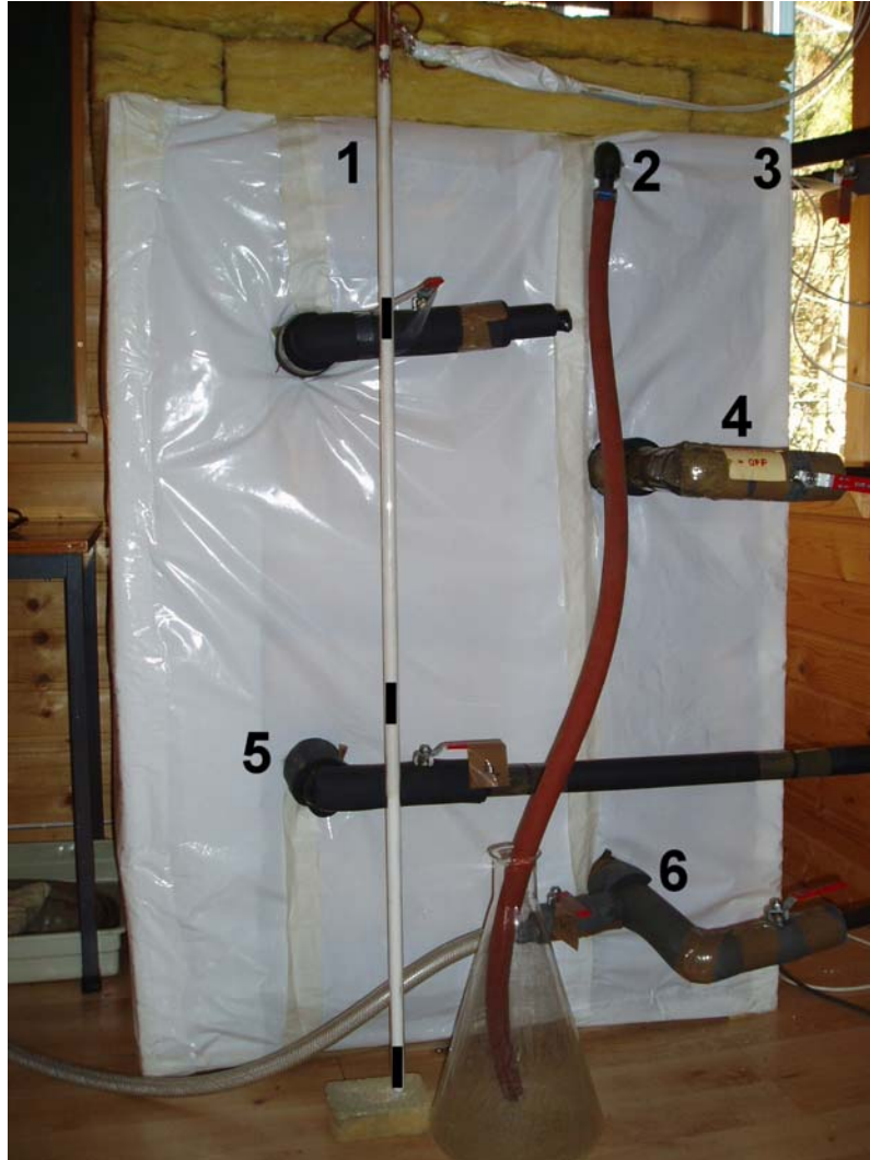
Figur 5.4: Varmelageret inne i sol-lab'en. 1) Dette røret står egentlig midt i tanken, men er her plassert på utsiden for å illustrere plasseringen av de tre temperatursensorene, markert med de svarte flekkene. 2) Røret der overskuddsvann kan renne ut. 3) Røret fra solfangerne og inn i tanken. 4) Tidligere brukt som innløp fra solfangerne, nå erstattet med nr 3. 5) Utløp til gulvvarmeanlegget. Dette er ikke brukt i forsøkene. 6) Røret der vann blir pumpet fra bunn av tanken og opp til solfangerne. Slangen til venstre gir mulighet for å tappe vannet ut av tanken.
