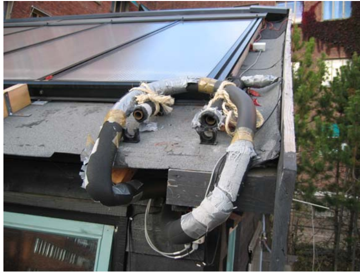
Figur 6.3: Bildet viser hvordan tilleggseksperimentet for å bestemme varmetapet fra rørene ble utført. Innløps- og utløpsrørene ble koblet fra solfangerne, og sammen som i en kortslutning.
