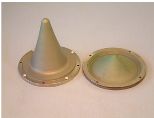
Figur 5. 1: Utjevningfilter for fotonbestråling. Filter for 24 MV-bestråling til venstre og 6 MV til høyre [University of the West of England 2004].
