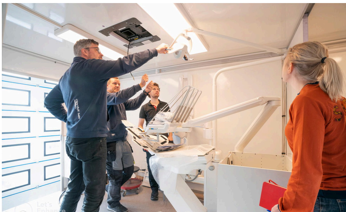
Bilde 3: Bilde av teknikere som jobber med installasjon av en unit som skal brukes til pasientbehandling bak i bilen. Dette er under konstruksjon og montering av den mobile klinikken (Kirkens Bymisjon, n.d.).
