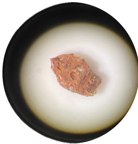
Figur 13 Løselighetstest av grundering før tilsetning av NaOH 21
