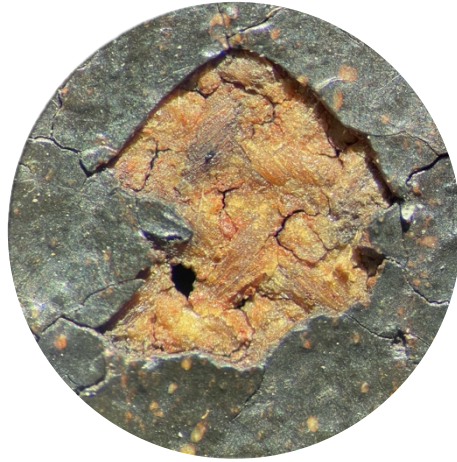
Figur 20 Avskalling i høyre hjørne. 40x forstørrelse
