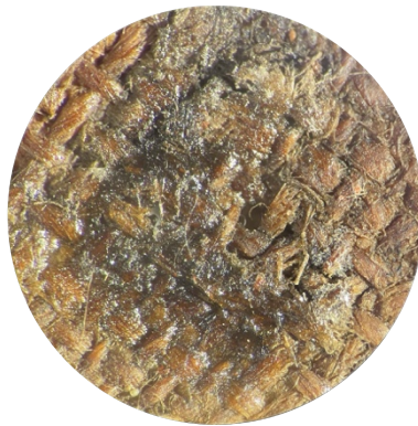
Figur 51 Etter påføring av størelim og hvetestivelse. Deretter Hollytex festet med Beva®371-film
