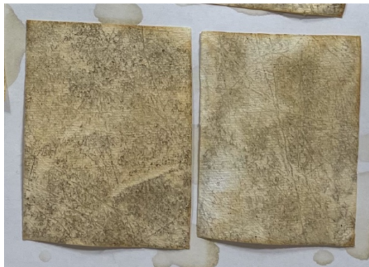
Figur 71 Evolon® med etanol etter 2,5 min på motivet. Betydelig mengde misfarget ferniss og støvpartikler.
