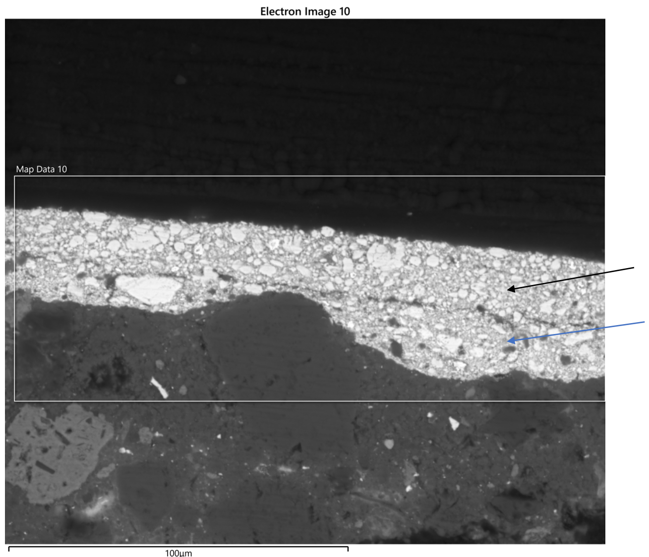
Figur 42 Tverrsnitt A i SEM. Denne illustrerer at det er en horisontal linje mellom de to hvite fargelagene.
