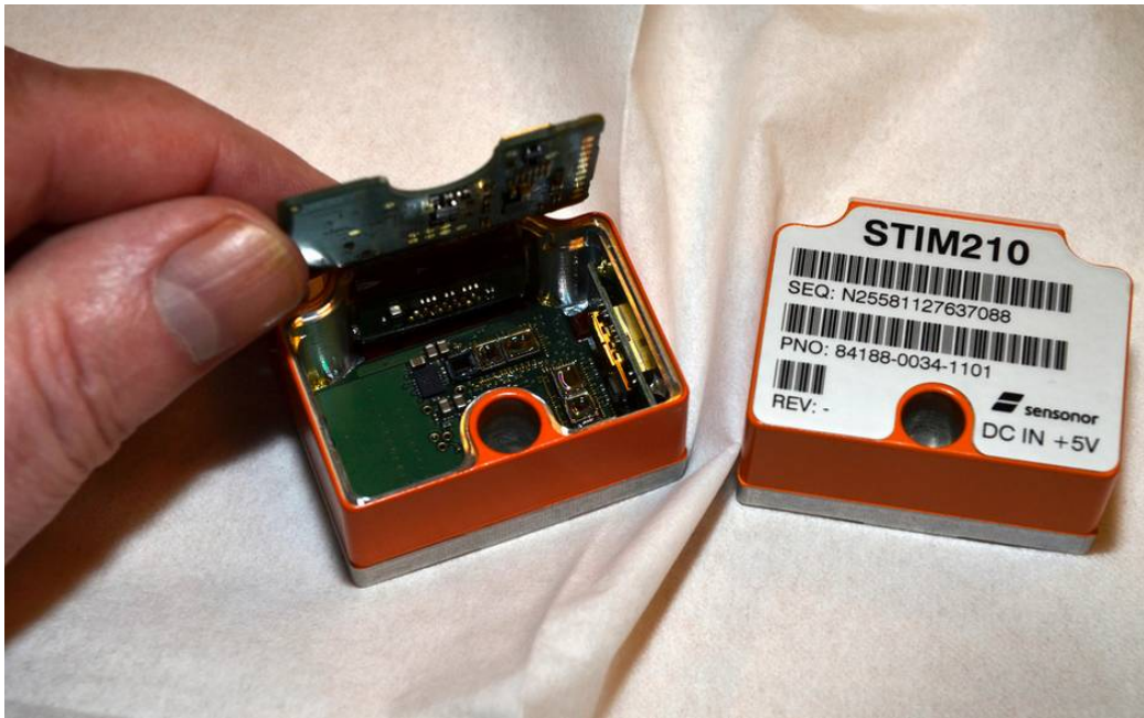
Figur 3.4: STIM210 er den nye høypresisjonsgyroen fra det norske selskapet Sensoror.[12]
