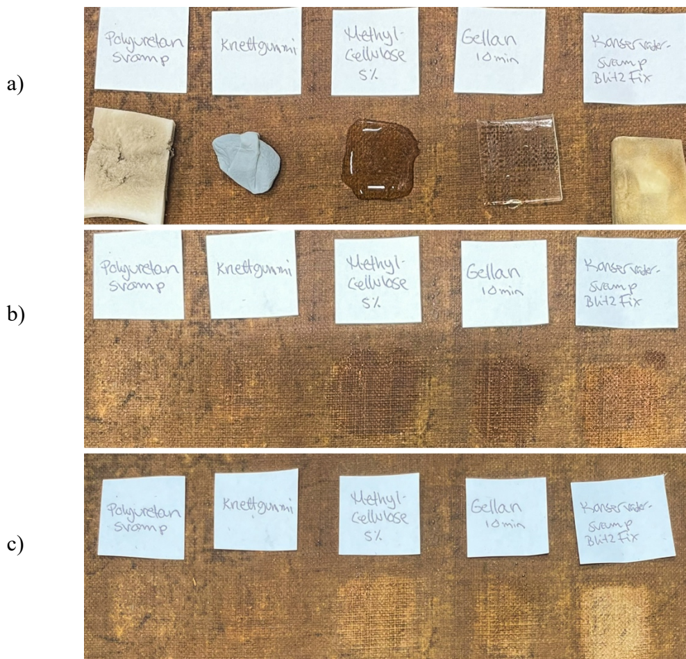
Sammenligning av polyuretansvamp, knettgummi, methylcellulose (5%), Gellan-gummi (2%) og konservatorsvamp Blitz-Fix for støvrensing. Blitz-Fix var mest effektivt.
