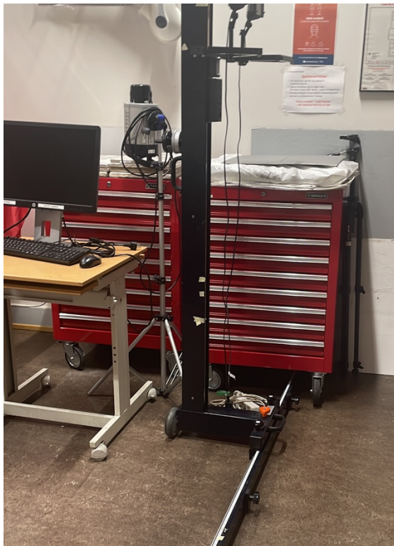
Figur 30 Oppsett av metoden for rekonstruksjonen med et stativ tilhørende Artist Camera, og en lasermåler festet med strips. Se Vedlegg 1 for ytterligere informasjon.
