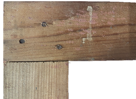
Figur 20 Næropptak av blindrammens sammenføyning, med originale, røde grunderingsrester.
