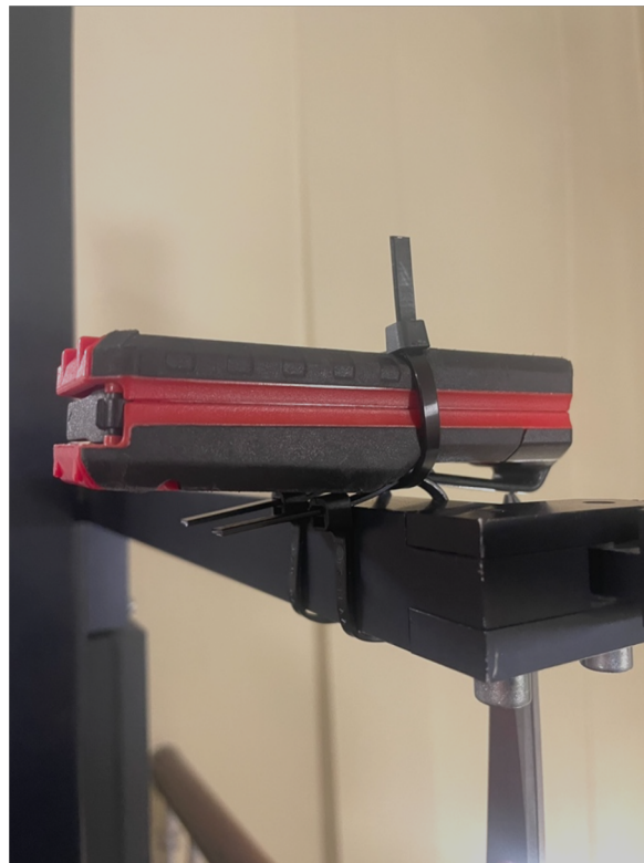
Figur 30 Oppsett av metoden for rekonstruksjonen med et stativ tilhørende Artist Camera, og en lasermåler festet med strips. Se Vedlegg 1 for ytterligere informasjon.
