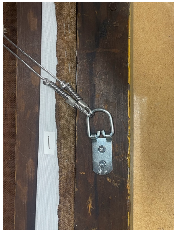
Figur 62 Vaier-endene festet med vaierlås, og surret rundt og gjennom tråden for å unngå slitasje på den høyre siden.
