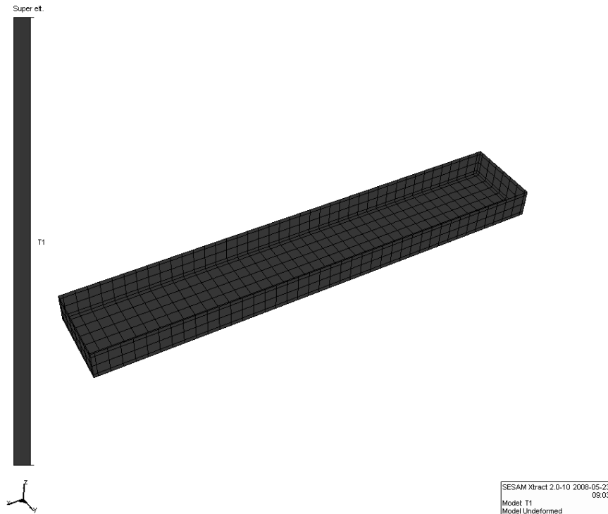
Figur 3.1: Modellen som er brukt til de hydrodynamiske analysene i Wadam. Definisjonen av aksekorset er x-aksen i lengderetning, y-aksen normalt på x-ksen i horisontalplanet og z-aksen normalt på x-y planet med positivretning oppover.
