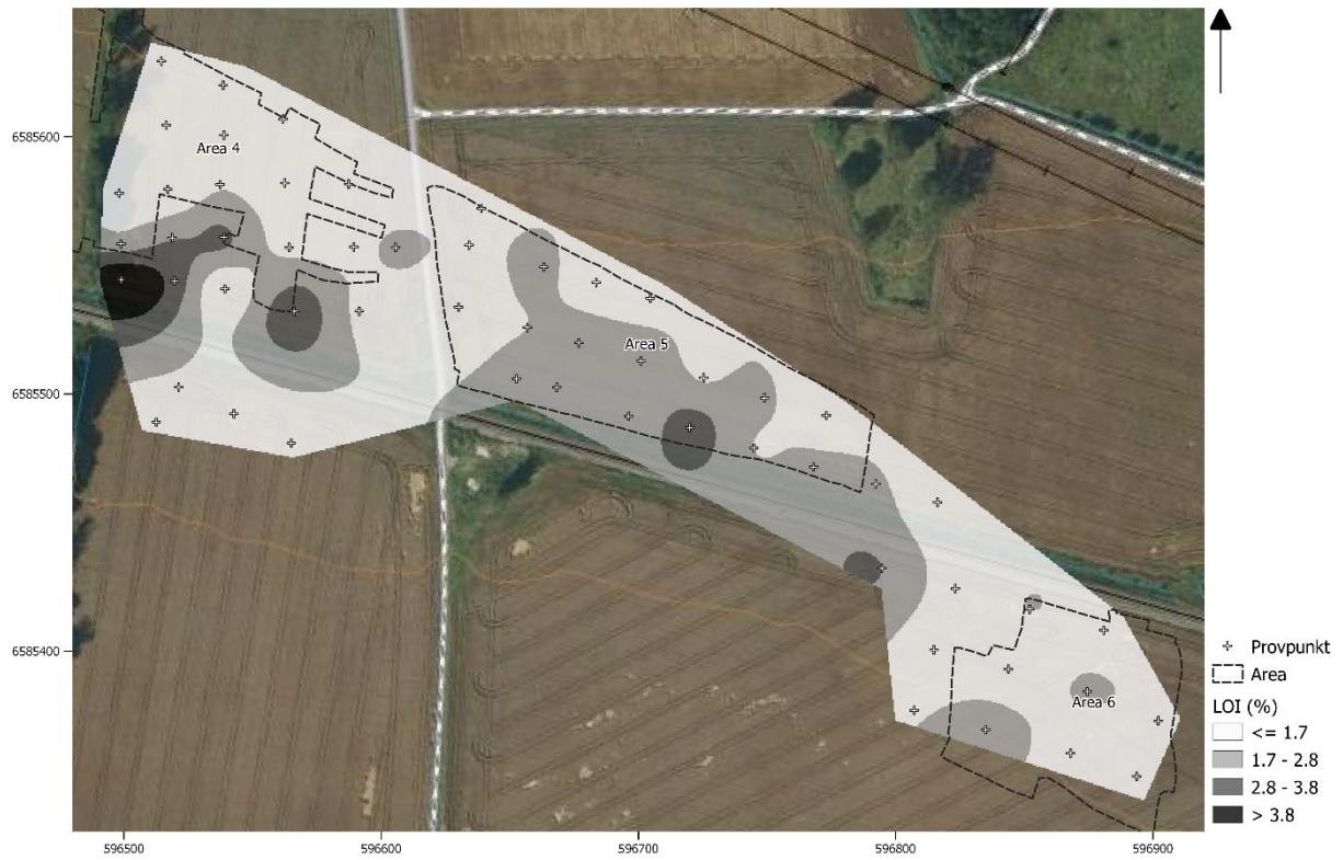
Figur 13. I figuren visas rumslig variation i Organisk halt, glödförlust över de karterade områdena och kan med fördel jämföras med figur 12.
