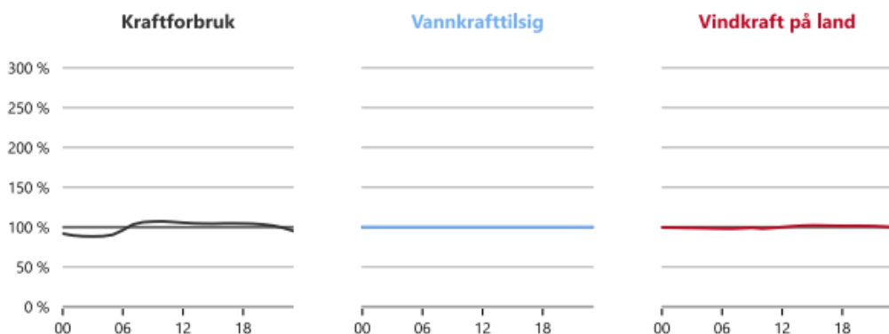
Figur 5. Døgnvariasjon for kraftforbruk, vannkrafttilsig, vindkraft på land og solkraft i Norge i prosent av gjennomsnittet. (NVE, 2020)
