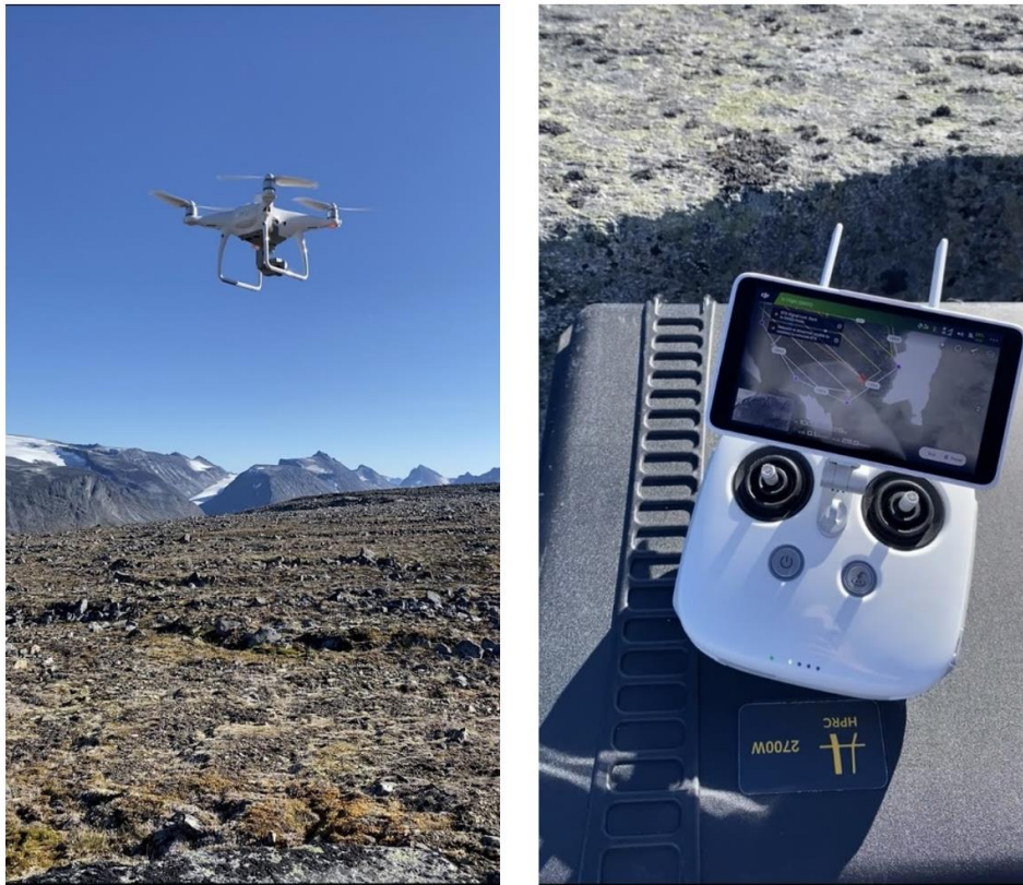
Figur 4.3. Bildet til venstre: dronen som ble fløyet på Juvflye. Her er den på vei opp til å ta bilder av stripene i flyområde 2. Bildet til høyre: Kontrollen til dronen. Skjermen viser banen dronen fløy i og bildet den akkurat tok (nede i venstre hjørne).
