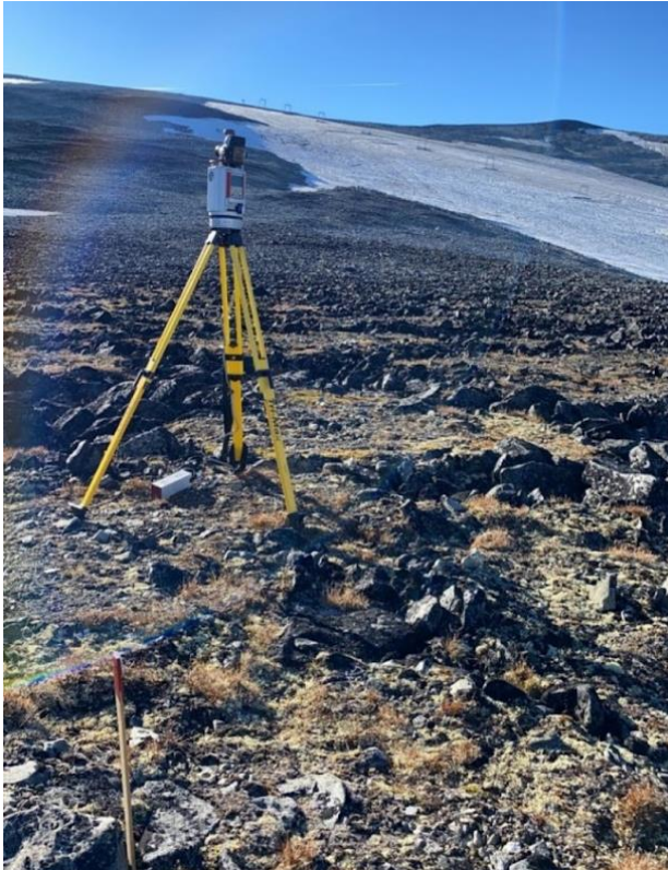
Figur 4.5. Bilde av oppsettet til laserskanneren med kameraet på toppen. I bakgrunnen er det mulig å se stolpene på skisenteret som ble brukt til å georeferere skanningene. Pinnen foran i bildet er en reflektor.
