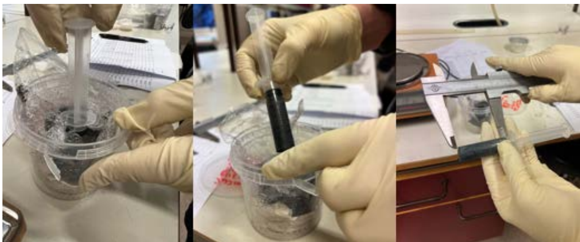
Figur 18: Prøve preparering av kvikkleire prøver 2
