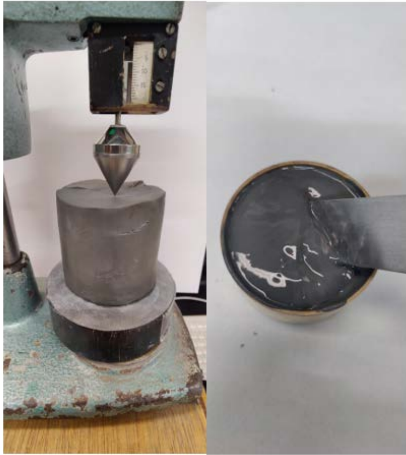
Figur 1: Bilde til venstre viser en omrørt kvikkleire, og bilde til høyre viser konustest med en 60g spiss av omrørt skjærstyrke.
