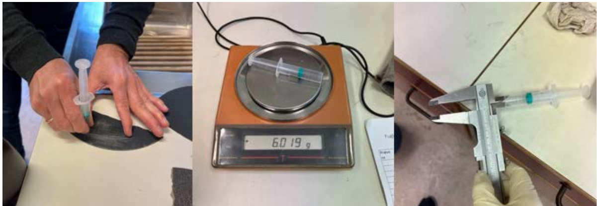
Figur 17: Prøve preparering av kvikkleire prøver 1
