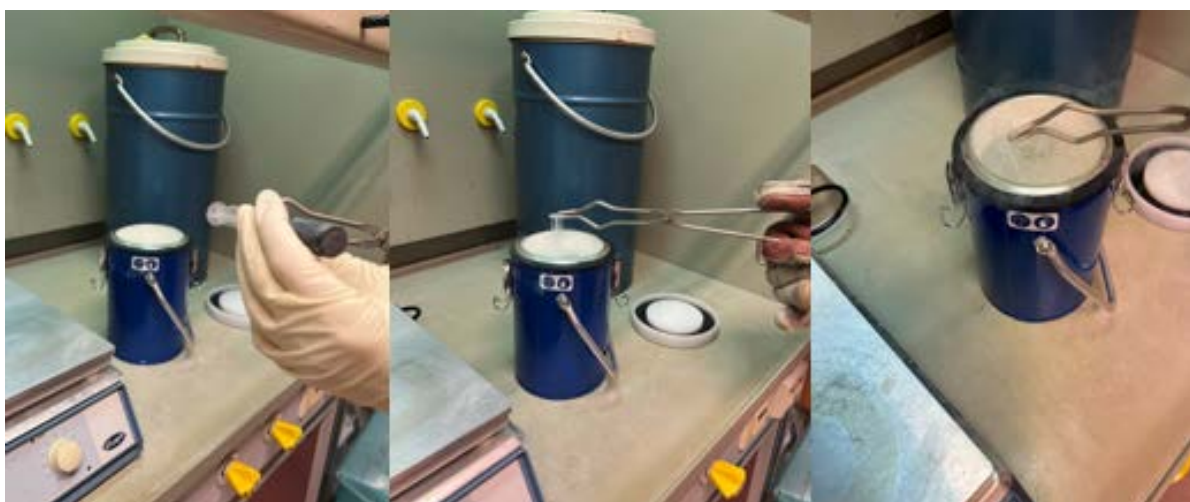
Figur 19: Prøve preparering av kvikkleire prøver 3
