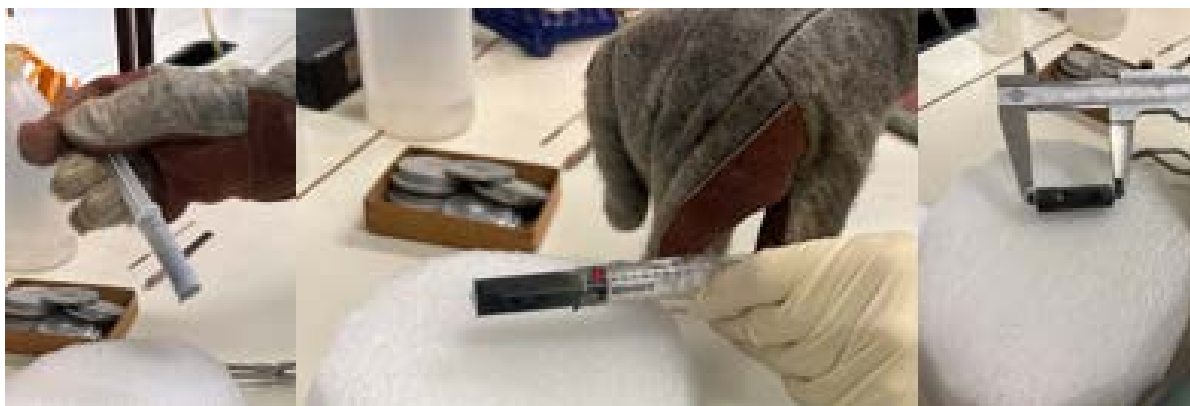
Figur 20: Prøve preparering av kvikkleire prøver 4
