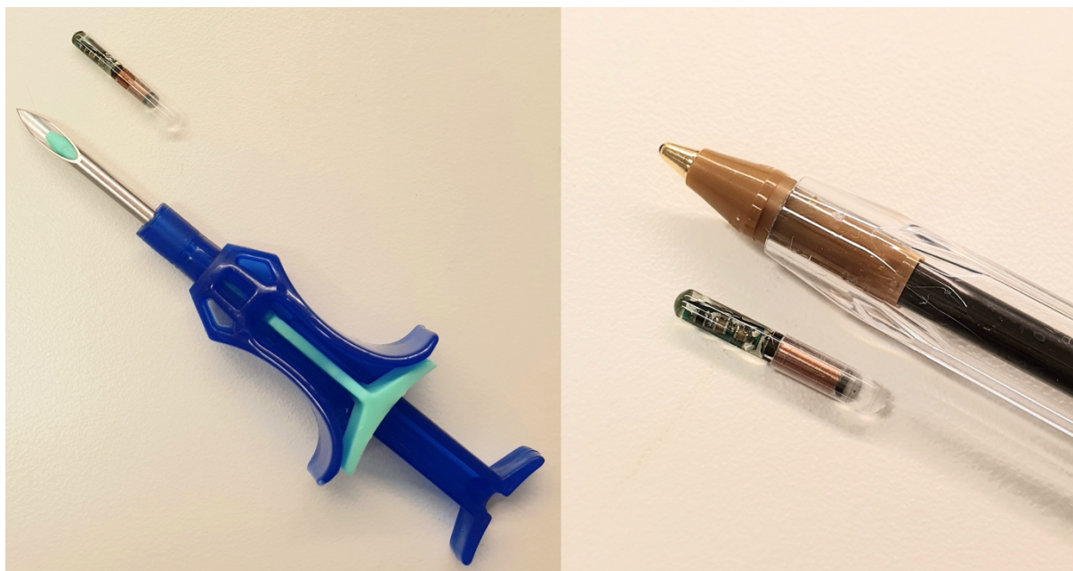
Figur 2.3 Temperaturtransponder (IPTT-300) med kanyle. Temperaturtransponderen er 14 mm lang og 2 mm bred og ble injisert s.c. over skulderen på musene. Temperatursensoren er avbildet ved siden av en kulepenn for å vise størrelsesforholdet.
