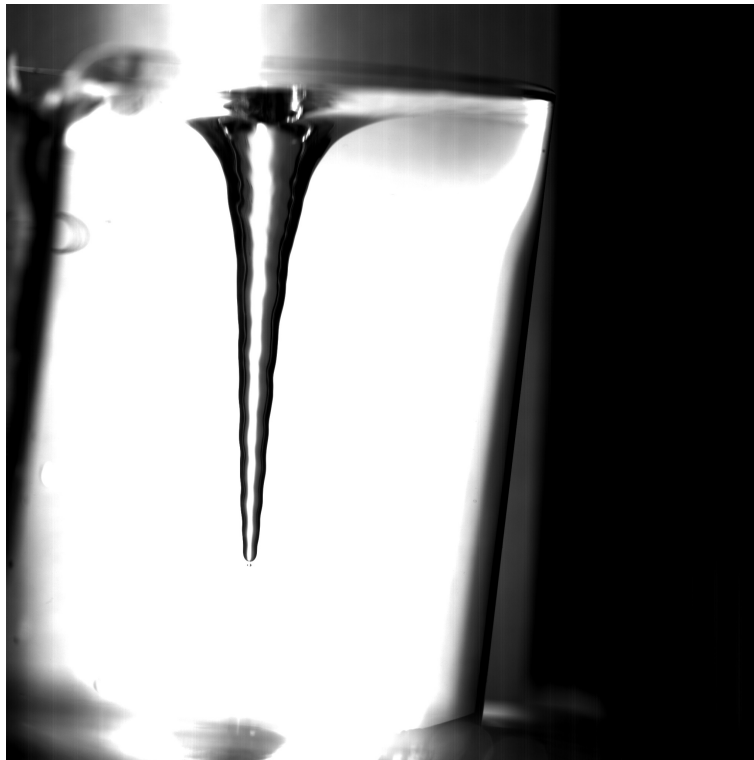
Figur C.1: Virvelstrøm med virvelfontene. Delvis åpnet sluk , renner vann over kanten
