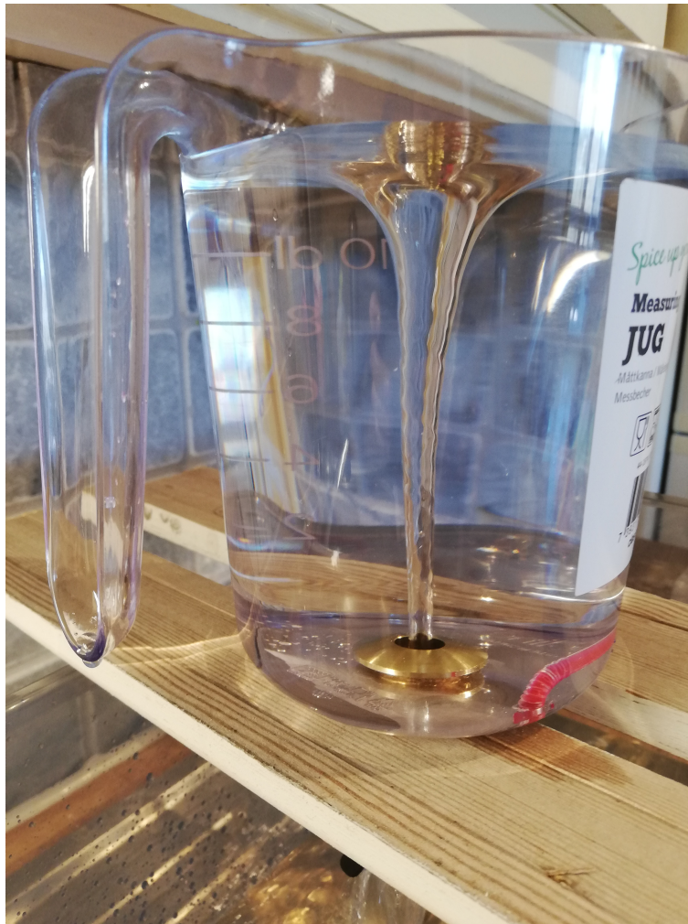
Figur C.8: Virvelfontene med helt åpnet sluk
