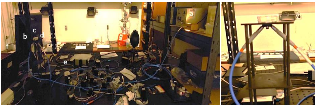
Figur 30 Oppsett brukt for måling av optiske egenskaper, a= lyskilde, b=lys inn mot prøve, c=prøven, d=inntak for lys reflektert fra prøven, e=detektor, f=PCen spektrometeret er koblet til.
