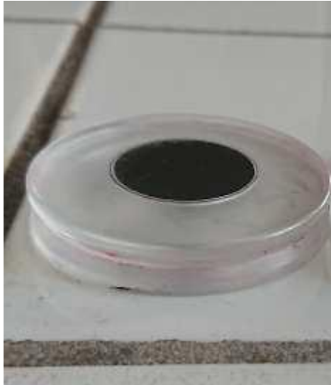
Figur 26: Eksempel på prøveholder brukt for røngendiffraksjon målinger gjort i Bragg-Brentano geometri
