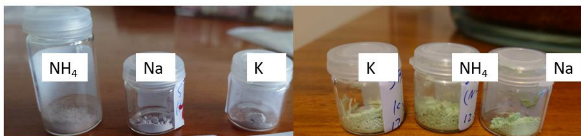
Figur 62: Kryolitt prøvene syntetisert. Fra venstre til høyre har vi (NH 4 ) 3 TiF 6 , Na 3 TiF 6 , K 3 TiF 6 , K 3 VF 6 , (NH 4 ) 3 VF 6 og Na 3 VF 6
