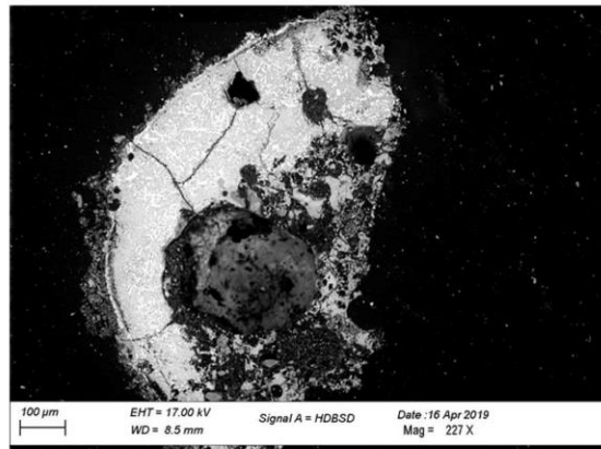
Figur 88: Kompakt, jernoxidholdig overflade på lerprøve P2036 stykke B
